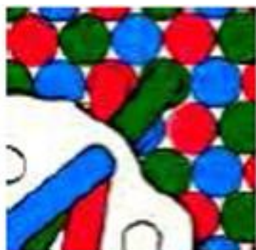
Obr.8. 6. Maska typu Delta CRT obrazovky
