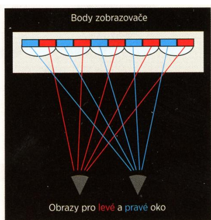
Obr. 8.27. Metoda lentikulárních čoček
