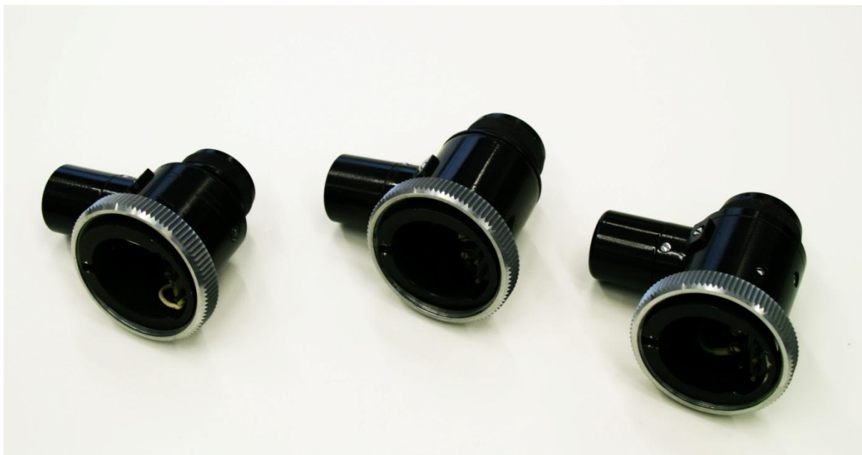
Obr.7.8. Autokolimační okuláry z goniometru GS5
