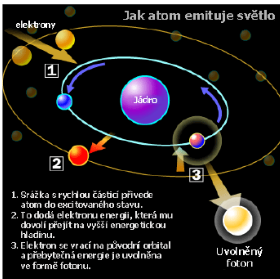
Obr.8. 16 – Schéma uvolnění fotonu z plynového iontu
