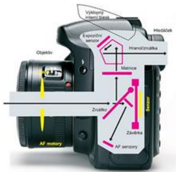
Obr. 11.15. Řez DSLR kamerou při měření a zaostřování
