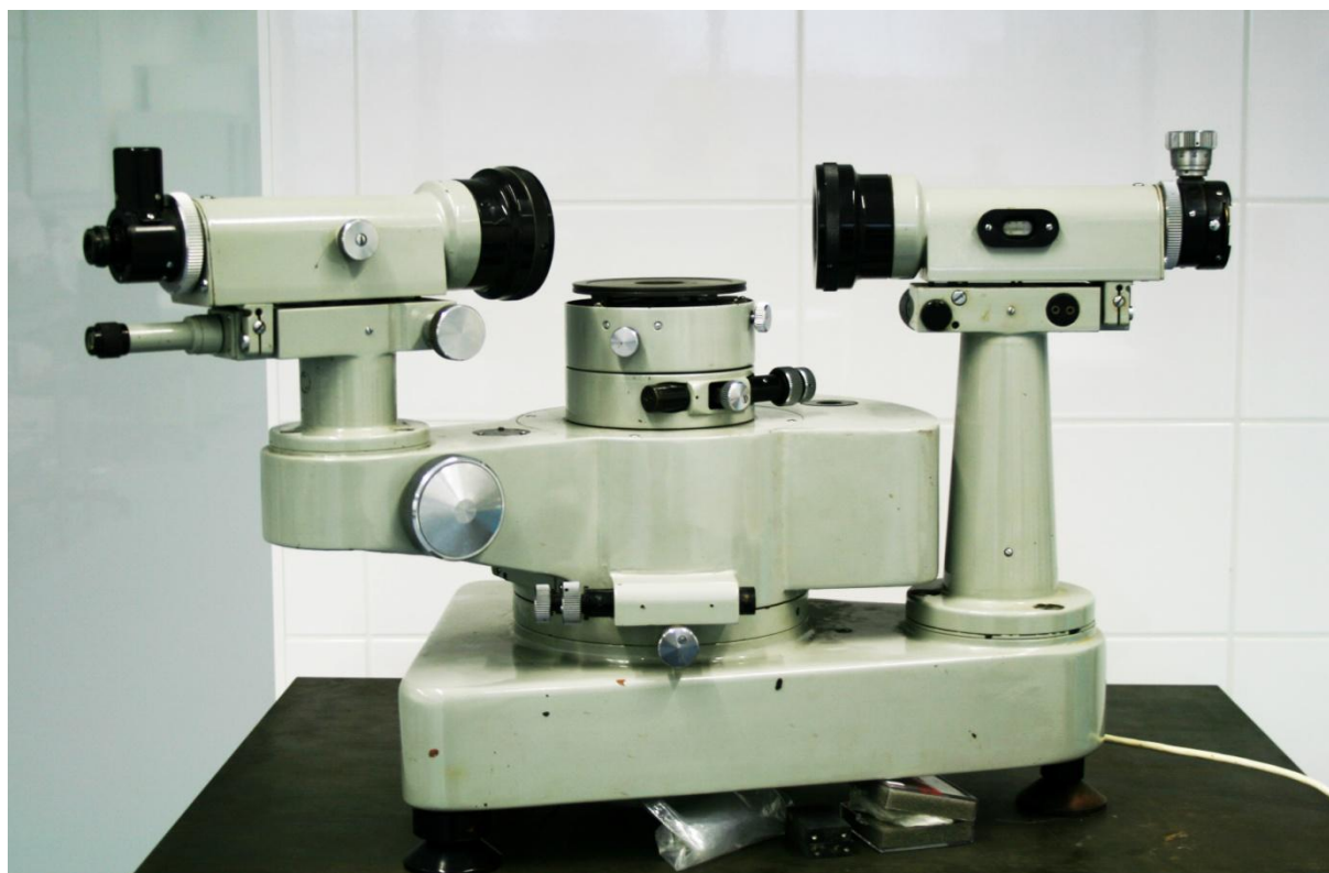
Obr. 7.11. Autokolimátor (vlevo) a kolimátor goniometru GS5
