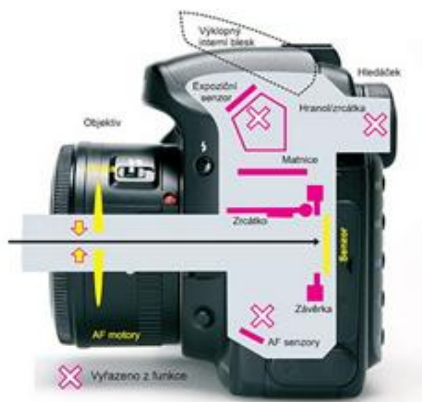
Obr.11.16. Řez DSLR kamerou při expozici
