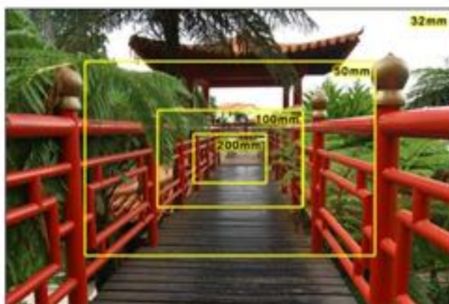
Obr.10.2. Zorné pole. (údaje platí pro obrazový formát 24 x 36 mm)
