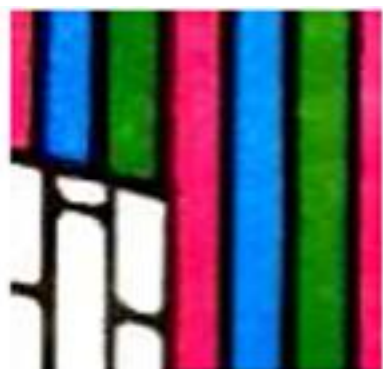
Obr.8. 8. Maska typu In line CRT obrazovky
