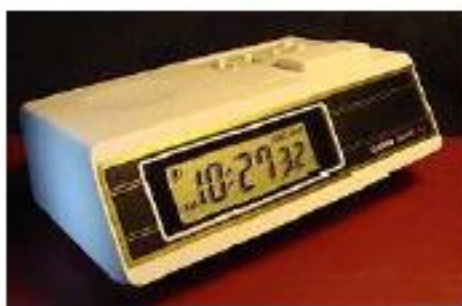
Obr.8. 10. Sedmi segmentový typ LCD displeje
