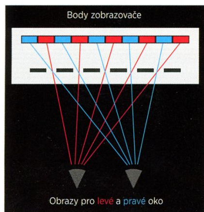
Obr. 8.26. Metoda paralaktické bariéry
