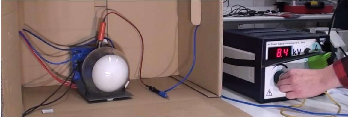
Obrázek 23 Katodová trubice sloužící k difrakci elektronů na tenké vrstvě grafitu
