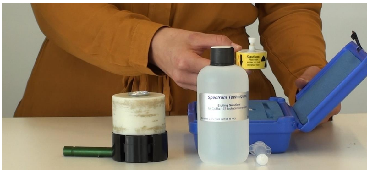
Obrázek 13 Sada k přípravě metastabilního barya – podstavec s miskou, vymývací roztok, stříkačka a generátor
