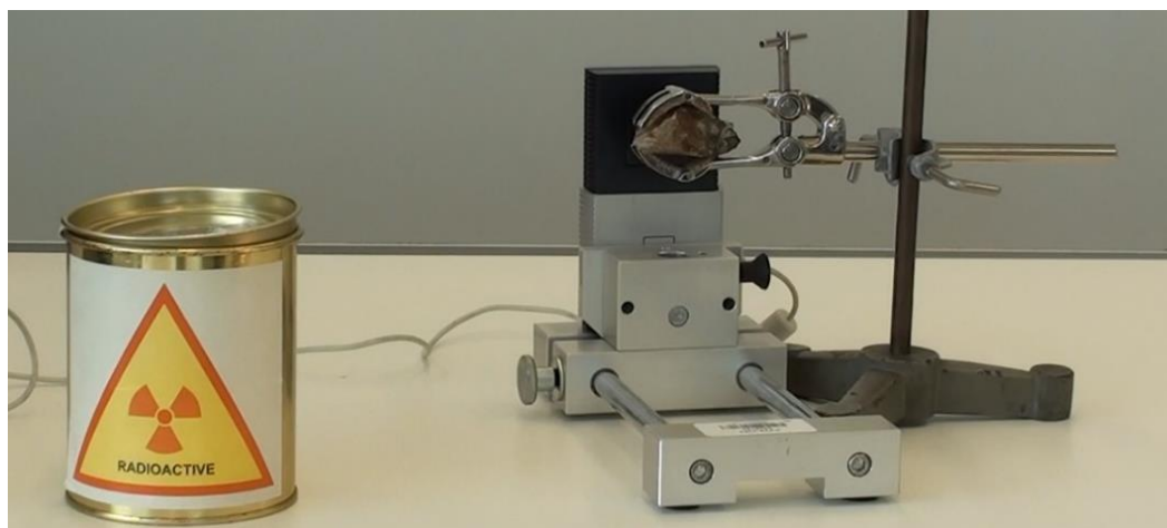
Obrázek 33 Detekce radioaktivního záření ze smolince s využitím digitální částicové kamery
