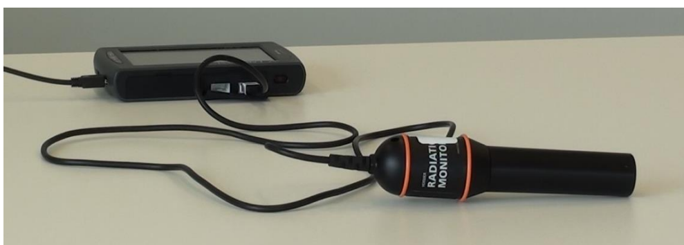
Obrázek 4 Detektor radiace připojený k dataloggeru LabQuest 3
