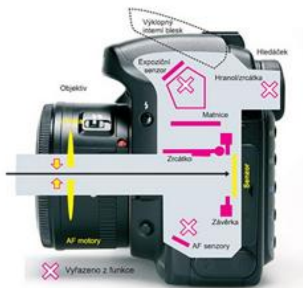
Obr.11.16. Řez DSLR kamerou při expozici
