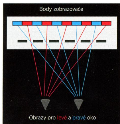
Obr. 8.26. Metoda paralaktické bariéry
