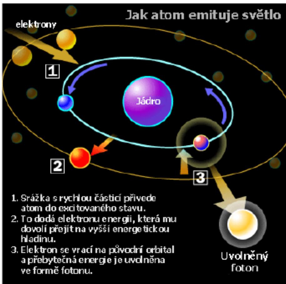
Obr.8. 16 – Schéma uvolnění fotonu z plynového iontu
