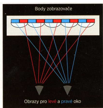
Obr. 8.27. Metoda lentikulárních čoček
